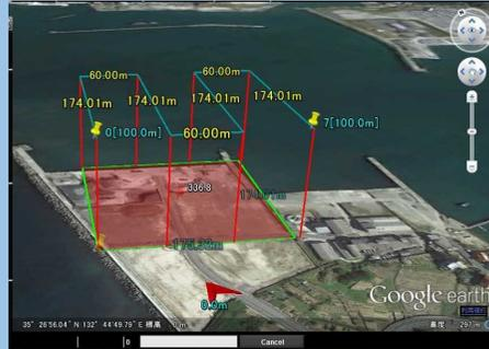
あらかじめ座標設定したルートを各種センサーにより自動操縦で飛行し、正確な位置での写真撮影が可能となるほか、操縦ミス等による落下の心配もありません。
