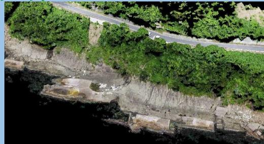
空中写真測量から点群に変換した三次元データの一例です。この三次元データを利用して三次元設計を行うことも可能です。
