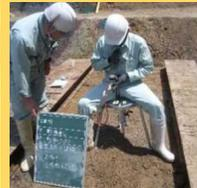
体重を反力として小径の円盤に载荷する試験です。平板载荷試験が行えないような狭小スペースでの支持力確認や平板载荷試験の補完としての利用に適しています。
