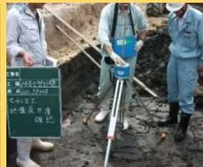
自由落下させたハンマーが地面に衝突したときの衝撃を測定し、 $C \cdot \phi \cdot CBR \cdot qu$ などの土質定数を推定します。結果はすぐに画面に表示されるため、対策の必要性などの方針決定までに時間を要しません。
