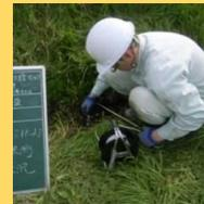
ボーリング孔に挿入したパイプにより地下水位の観測を行います。自記式水位計による連続測定も可能です。
