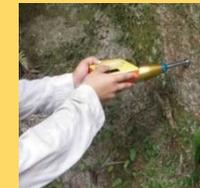
バネの反発を利用して、地盤の硬さを測定します。土軟硬区分の指標としたり、一軸圧縮強度の推定に利用します。
