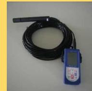
工事現場における水質の変化を濁度計を用いて事前事後調査を行います。
