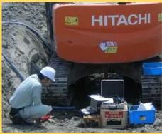
地盤上においた円盤に油圧ジャッキで荷重をかけ、地盤の極限支持力や変形特性を求める試験です。リアルタイムでデータをPCに取り込み、グラフを確認しながらの試験が可能です。
