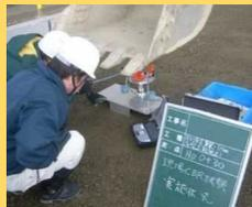
ジャッキでシリンダーを貫入させ、路盤・路床の原位置でのCBR値を求める試験です。リアルタイムでデータをPCに取り込み、グラフを確認しながらの試験が可能です。
