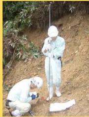
重りによる打撃でロッドを貫入し、土層の硬軟を調べます。斜面上の不安定土層の厚さや支持地盤の深度の確認に利用します。
