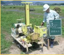
重りと回転によりロッドを貫入し土層の硬軟や分布を調べ、換算N値・一軸圧縮強度・許容支持力を推定します。支持力の検討や軟弱地盤の分布確認に利用します。
