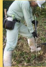
先端コーンを測定したい深度に貫入させ、コーン回転時の周面摩擦を測定することで土の粘着力や内部摩擦角を求めます。
