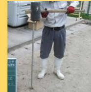
簡易動的コーン試験孔などを利用して小規模で簡易な方法もご提案できます。
